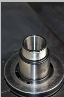
Remove nut from ER holder
