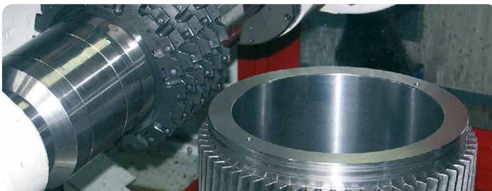
Vorfräsen mit Wälzfräser Stirnrad Modul 12, z = 45 Werkstoff: 18CrMo6
