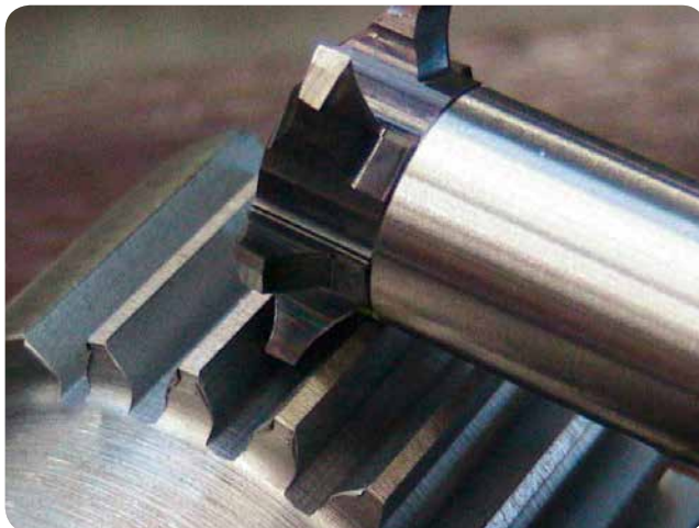
Schlichtfräser Modul 2; z = 23 Gear finish mill module 2; z = 23
